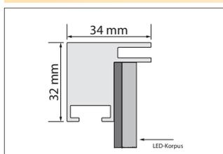
**textil-spannrahmen alu LED Profil**
